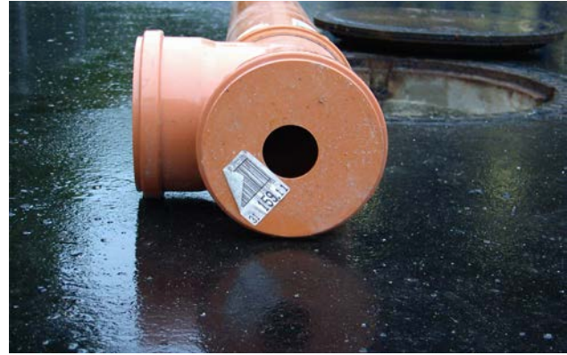
Detailaufnahme der projektspezifischen Drosselblende
